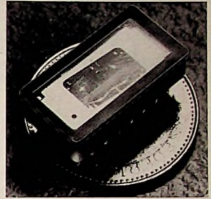
De 7-segment minitron van Mitsui welke met een gloeidraadsysteem werkt.
