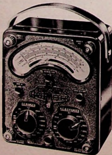
Het klassieke voorbeeld van een analoge multimeter, de AVO model 8. Richtprijs f 385,—.
