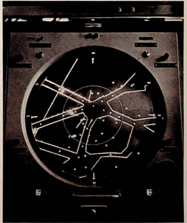
Afb. 2 - Radarc ntrole-eenheid waarop ook de luchtkorridors staan aangegeven volgens welke route toestellen Schiphol kunnen aanvliegen. Men kan duidelijk drie toestellen herkennen aan de stippen die een nalichtende streep achter zich hebben.
